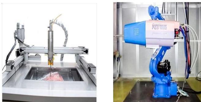
Рисунок 3. Автоматизированные комплексы для нанесения ХГН-покрытий [7]
