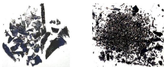
Сурет 1. Балқымадан шынықтыру арқылы алынған бастапқы заттар: а) – пластинкалар, б) – сфералар
