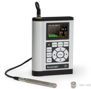
Сурет 2. «Ассистент SI» 1-дәлділік класы спектрлік талдағыш
